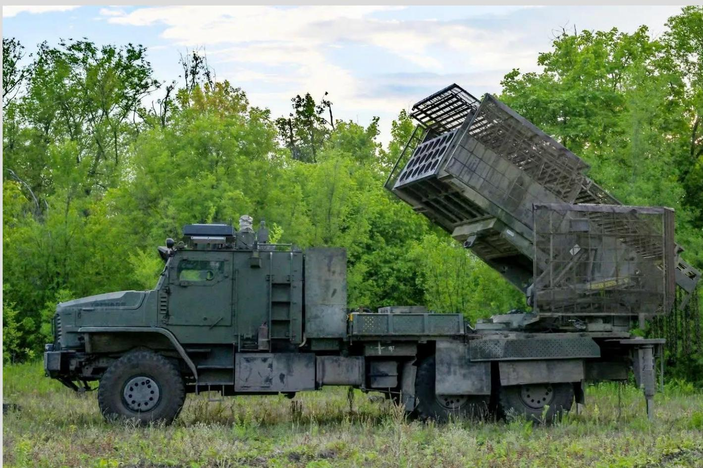
Baseado agora num chassis de viatura de rodas de 3 eixos, 6x6, Ural 63704-0010 Tornado-U, de cabina blindada (em lugar do anterior chassis do carro de combate T-72 ou T-90) e com um total de 18 tubos lançadores (em lugar dos anteriores 24), com uma redução de massa das anteriores mais de 40 toneladas para cerca de 20 toneladas, privilegiando, assim, uma maior mobilidade em operação entre posições.
